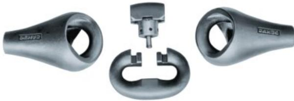
**Allgemein:** Dauerhafte Endverbindung für Drahtseile. Diese Seilverbindung ermöglicht schnelles Wechseln von Lastaufnahmemitteln durch einfaches Lösen und Anschließen der Greifer-Hubwerkseile an die Schließseile des Hubwerks.
